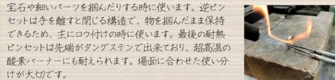
宝石や細かいパーツを掴んだりする時に使います。逆ピンセットは手を離すと閉じる構造で、物を掴んだまま保持できるため、主にロウ付けの時に使います。最後の耐熱ピンセットは先端がタングステンで出来ており、超高温の酸素バーナーにも耐えられます。場面に合わせた使い分けが大切です。
